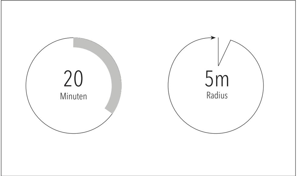
Die fm STADIO Bürostehleuchten sind zusätzlich zur Luminosity Range Control mit einem Präsenzmelder zur Erfassung von Bewegungen am Arbeitsplatz ausgestattet werden. Die Abschaltzeit des Präsenzmelders beträgt 20 Minuten. Wird in dieser Zeit keine Bewegung im Umkreis der Leuchte registriert, schaltet sich die Leuchte in den stromsparenden Standby-Modus.
