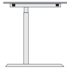
FM66 FLACHKUPE RUNDROHR stufenlose Höhenverstellung von 650 – 850 mm durch das Lösen einer Inbusschraube Gestellfarbe: Silberaluminium
